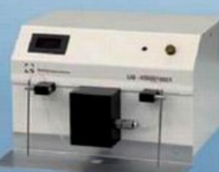
Лабораторный гомогенизатор молока и молочных продуктов высокого давления на лабораторном уровне в измерительных и научно-исследовательских лабораториях.
