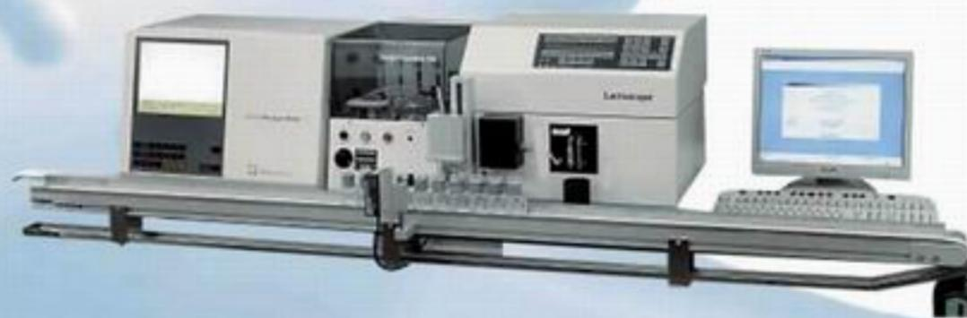
Комбинированные приборы (LactoScope™ и SomaScope™) для определения качества и состава молока и количества соматических клеток.
