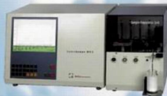
Высокоскоростной анализатор для высокоточного определения количества соматических клеток в непастеризованном молоке (метода проточной цитометрии).
